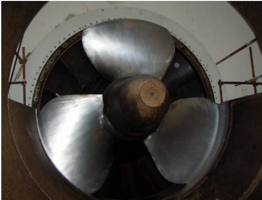
Fotografia a mračno bodov turbíny na vodnom stupni Čuňovo VD Gabčíkovo
